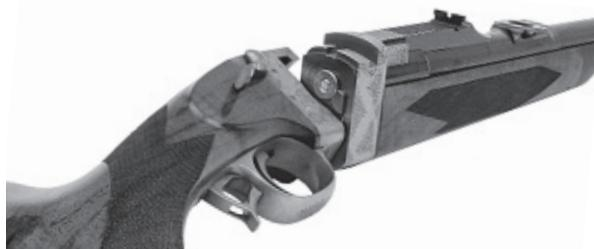
Zum Laden wird der seitliche Verschlusshebel betätigt und der Lauf nach rechts weggedreht. Die Waffe wird nun geladen und der Lauf zurückgeschwenkt. Die Büchse kann nun völlig gefahrlos geführt werden, erst unmittelbar vor dem Schuss wird das Schloss über den leicht bedienbaren Spannhebel gespannt.
